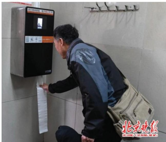
necessario posizionarsi davanti allo scanner facciale e in seguito il distributore emetterà 60 centimetri di carta. Se ci fosse necessità di ulteriore carta bisognerà attendere 9 minuti prima di poter fare una nuova richiesta e il software potrà
