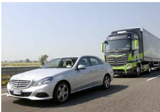
darsi da solo. Per adesso, in una calda mattinata di primavera inoltrata, sull'A21, e più precisamente sul tratto tra Caorso e Cremona, un Mercedes Actros ha messo in mostra le proprie caratteristiche tecniche quali il **controllo radar della velocità di crociera**, il **sistema di mantenimento della distanza di sicurezza** e della **frenata automatica**. Frenata che,
