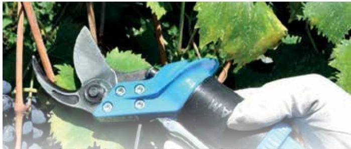
**FORBICI PNEUMATICHE PER LA POTATURA** con lame a doppio taglio per diminuire lo sforzo dell'operatore
